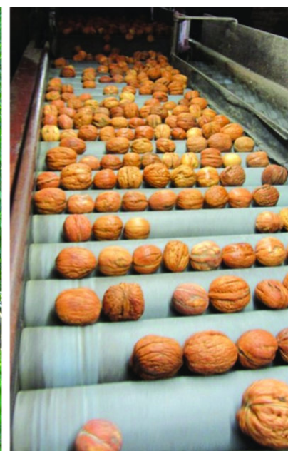
Obtención mecanizada de nueces de los árboles (izquierda) mediante vibración y clasificación por tamaño (derecha). Buxusberg
